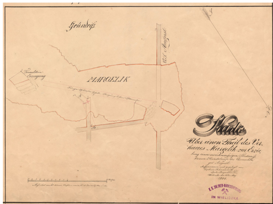
5. Projekt chodnika wyposażonego w tor dla wózków, tzw. psów węgierskich, w komorze Margielnik. Wieliczka 1844 r., Z. Schoenowitz, Wieliczka, nr inw. VII/195
