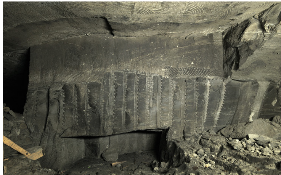
11. Komora Ksawer Górny. Ocios i strop chodnika rozcinającego pokład soli spizowej. Czola wrębów i negatywy klinów żelaznych odrywających kłapcie (fot. K. Kozłowski)
